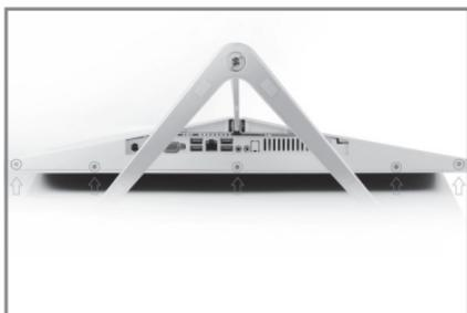
(۱) پیچ های نصب شده در لبه زیر دستگاه را باز کنید.
