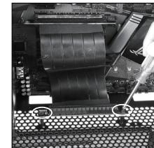
به کمک پیچ، سمت دیگر کابل رایزر را به دو پایه از پیش نصب شده مکم کنید
