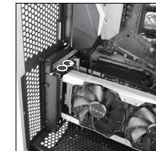
پس از نصب کارت گرافیک درون شکافت رایزر، با استفاده از پیچ های همراه کیس کارت گرافیک را در جای خود مستقر کنید
