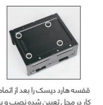
ابتدا چهار پیچ SSD بالایی را نصب کنید سپس حافظه دیگر را وارد و توسط چهار پیچ محکم کنید
