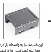
ابتدا چهار پیچ SSD بالایی را نصب کنید سپس حافظه دیگر را وارد و توسط چهار پیچ محکم کنید
