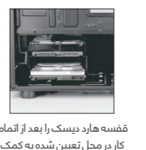
ابتدا به کمک چهار پیچ هارد دیسک بالایی را نصب کنید سپس هارد دیسک دیگر را وارد و توسط چهار پیچ محکم کنید
