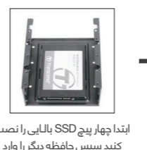
قفسه هارد دیسک را بعد از اتمام کار در محل تعیین شده نصب و به کمک چهار پیچ مربوطه محکم کنید
