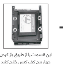
ابتدا به کمک چهار پیچ هارد دیسک بالایی را نصب کنید سپس هارد دیسک دیگر را وارد و توسط چهار پیچ محکم کنید
