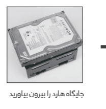
این قسمت را از طریق باز کردن چهار پیچ کف کیس خارج کنید
