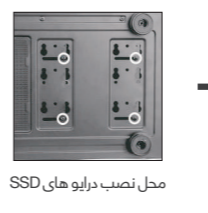
این قسمت را به واسطه باز کردن چهار پیچ کف کیس خارج کنید
