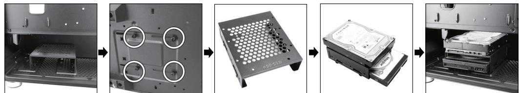
\* محفظه هارد جلوی پاور، دارای قابلیت باز شدن می باشد. در صورتیکه از باورهای خلی بزرگ استفاده می نمایید، شما قادر خواهید بود که این محفظه را به راحتی و به وسیله چهار پیچ از سمت کف کیس جدا نمایید (با اینکه از قابلیت تنظیم کشوی آن به سمت جلو یا عقب کیس استفاده نمایید) و برای نصب هارد ۳.۵ اینچی خود، لازم است ابتدا این محفوظه را از روی کیس جدا نمایید.
